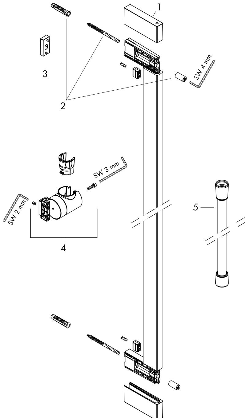
**Unica****Brausenstange E Puro 90 cm mit Easy Slide Handbrausenhalter und Brausenschlauch**Oberfläche: **Brushed Bronze** Artikelnummer: **24403140****Ersatzteilliste**
